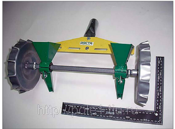
Сеялка СМК-2 (двухрядная, регулируемое междурядье)
