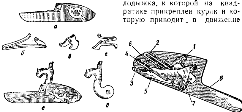
Рис. 6. Подкладной замок куркового ружья:
