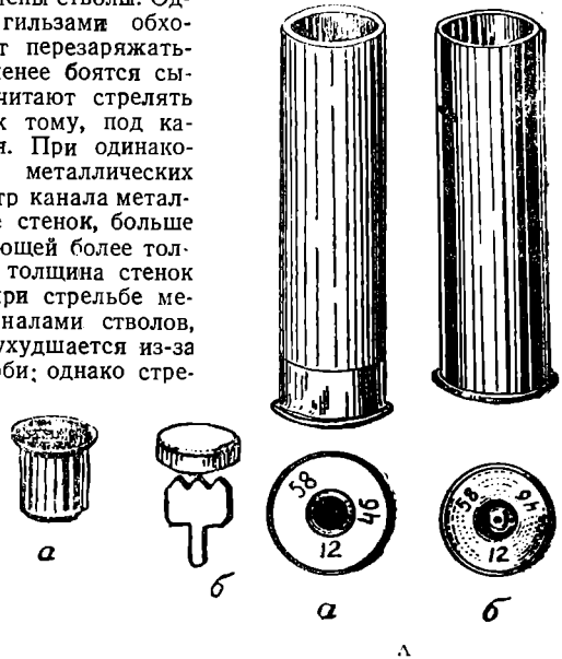
Рис. 42. А. Папковая (а) и металлическая (б) гильзы. Б. Закрытый капсюль типа «Жевело» (а), обыкновенный капсюль с наковальной (б)
